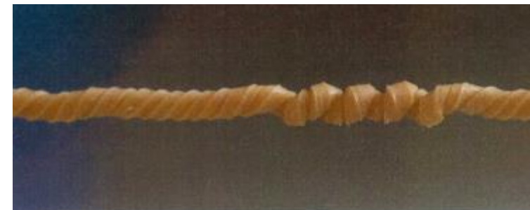
Obrázek 4: První očka sekundárního vinutí.
