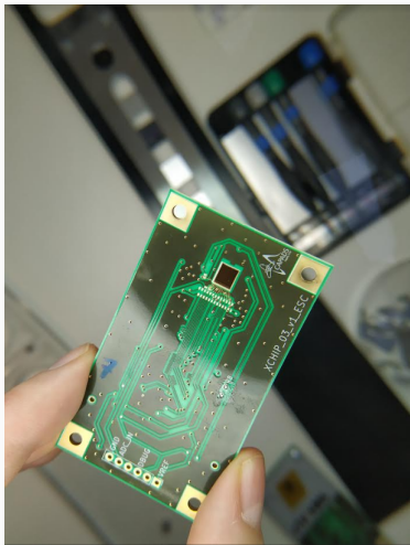
Figure 5: Detekční čip nabondovaný na plošném spoji.
