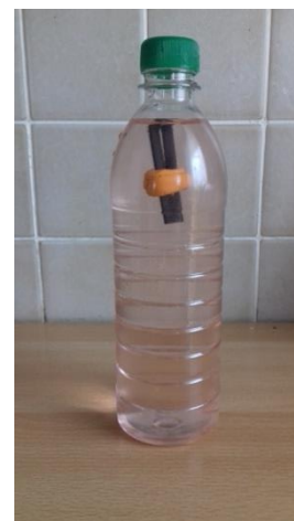
Obrázok 15: Zostrojená fľaša s potápačom
