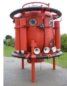
Obrázok 17: Moderný potápačský zvon (Zdroj: https://bit.ly/2Zvv4eU )
