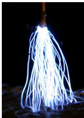
Obrázok 2 Plazmový výboj použitý na prípravu PAV (prechodová iskra s elektrosprejom vody)
