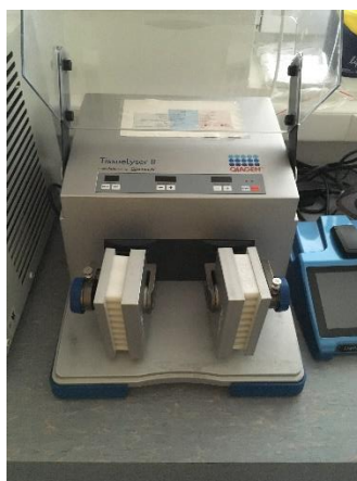
Obrázok 6 Homogenizátor Qiagen TissueLyser II
