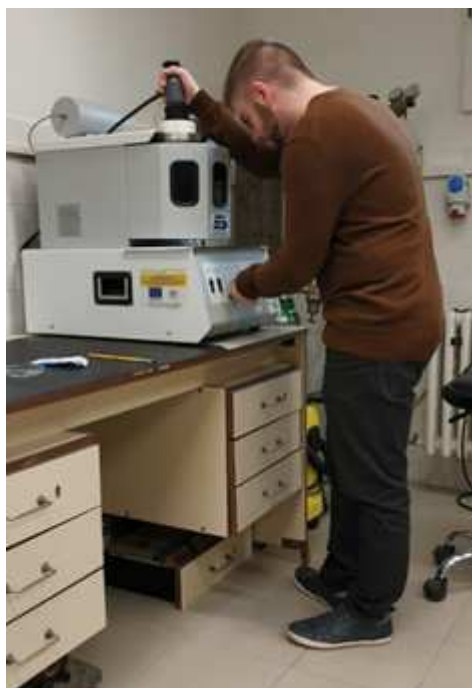
Obr. 16: Príprava vzorky v oblúkovej peci
