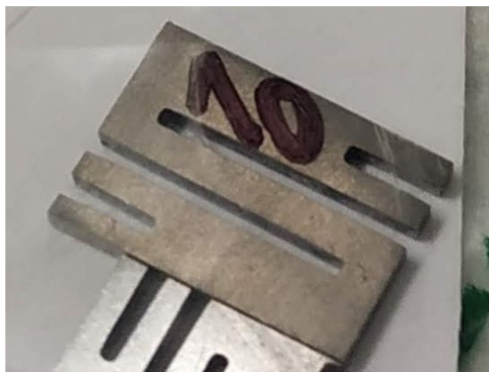
Obrázek 3.5: Připravený vzorek na měření elektrického odporu — rezistivity
