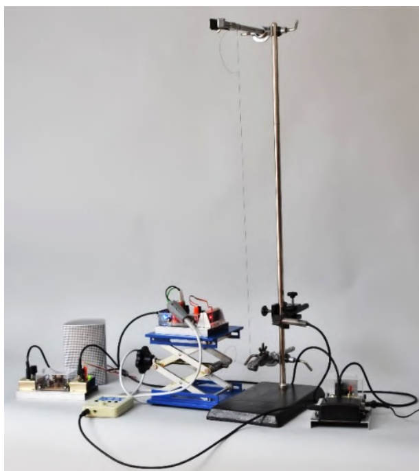
Obr. 3 Zostava pri meraní vibrácií struny Zdroj: [24]
