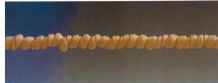
Obrázek 5: Dokončené sekundární vinutí. Při dalším točení se toto vinutí zhušťuje a narůstá napětí v krutu, a proto se opět začíná vlnit (viz další obrázek).
