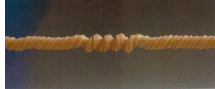
Obrázek 4: První očka sekundárního vinutí.
