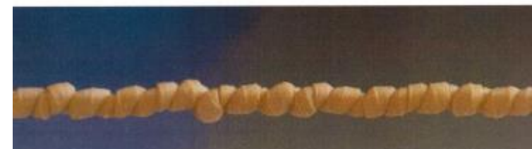
Obrázek 4: První očka sekundárního vinutí.
