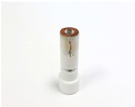
Obr. 12: Spodní díl dilatometru s viditelně vysunutým vzorkem v jeho středu
