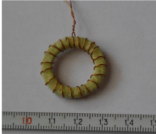
Obr. 8 [Vzorka oblepená izolačnou papierovou páskou s navitými 21 závitmi, pripravená na meranie frekvenčnej závislosti permeability]
