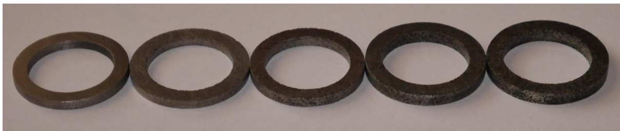
Obr. 1 [Prstencové vzorky zoradené zľava doprava podľa stúpajúceho percentuálneho obsahu ATM.]
